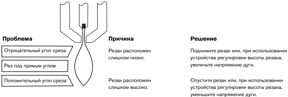
Рисунок 4 – Углы среза
